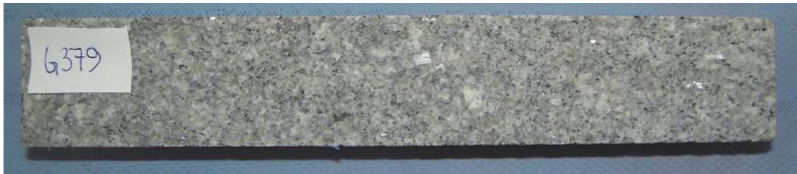
Figur 1. Prov G3779 med sin homogena grå färgton. Provet är lätt fuktat.
