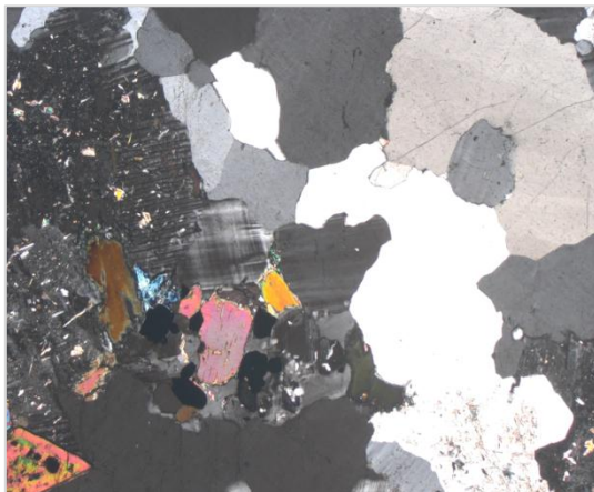
Figur 2. Foto av ”frisk” mörkbrun och rödaktig biotit, centralt till något vänster i bild. I höger bildkant uppträder kvarts i vitt och vitgrå färg. I vänster bildkant uppträder mörkgrå fältspat med svag sericitomvandling. I vänster nedre bildhorn uppträder rosaröd titanit. Foto taget med 5 gångers förstoring. Ytan motsvarar 2,8 X 2,1mm.
