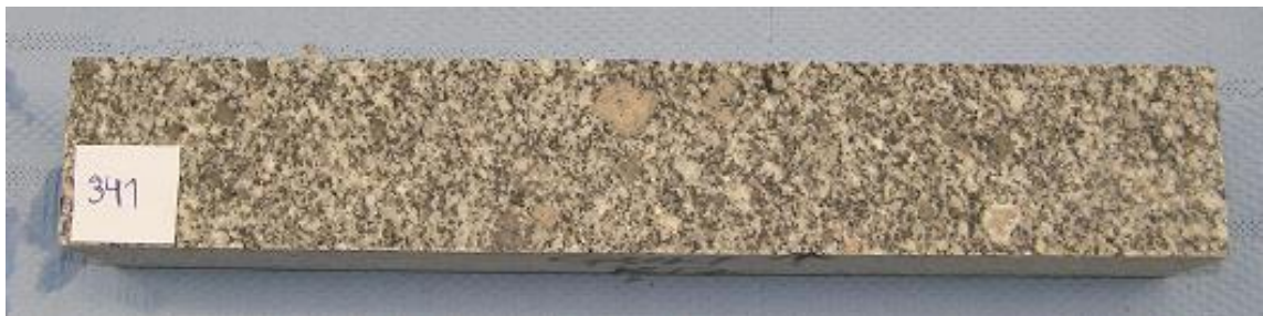
Figur 1. Prov G3741 med sin grå-vit-svarta grundmassa, som ger bergarten ett något ”prickigt” utseende. I mitten av bild förekommer typisk megakryst, ca 1 cm av ljusrosa pertitisk mikroklin.
