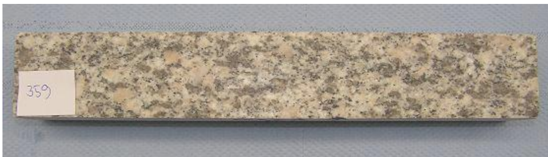
Figur 1. Prov G3759 med sin grå till rosaljusgrå färg. Större korn i rosa ton utgörs av pertitisk mikroklin.
