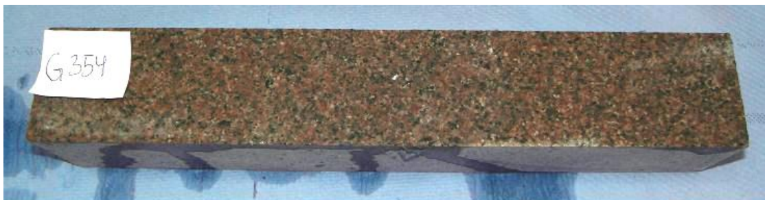
Figur 1. Prov G3754a med sin dominerande djupröda grundmassa. Svart biotit, som uppträder något heterogent, ger naturstenen ett fläckigt utseende. Provet är lätt fuktat.
